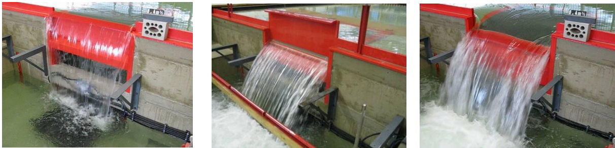
Abb. 4: Betriebszustände: KW-Betrieb (li.), Rechenreinigung (mi) Geschiebe- und HW-Spülung (re.)
