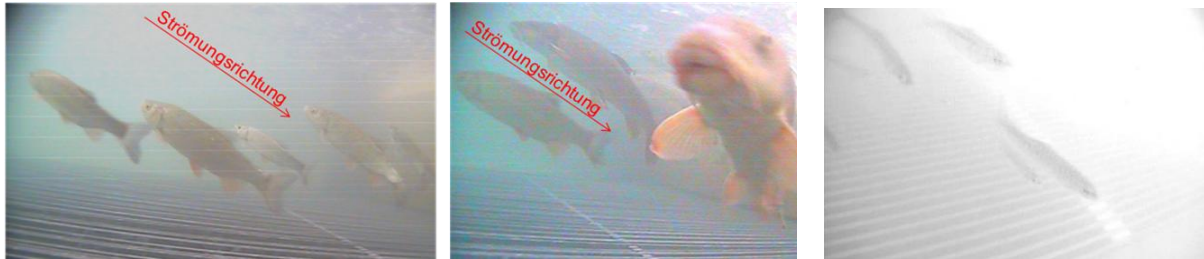
Abb. 8: Fischbewegung über der horizontalen Rechenebene (li. Aitel, mi. Barben, re. Jungfische)
