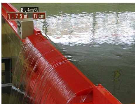
Abb. 2: Überströmte Verschlussstafel (li.) und Triebwasserweg mit KW-Längsschnitt (re.)
